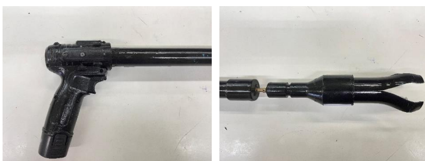
ภาพที่ 8 แสดงส่วนส่วนมือจับสว่านไฟฟ้าเพื่อใช้ควบคุมการหมุนเกลียว ถอด เปลี่ยนหลอดไฟ
