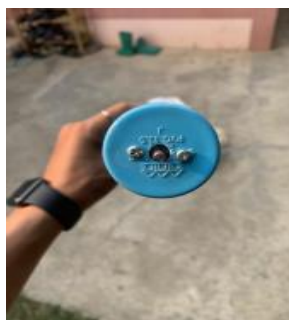
ภาพที่ 5 ติดตั้งตัวมอเตอร์ที่ทำให้ส่วนหัวหมุน
