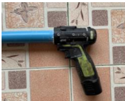
ภาพที่ 4 สวิตช์ควบคุมการทำงานของมอเตอร์
