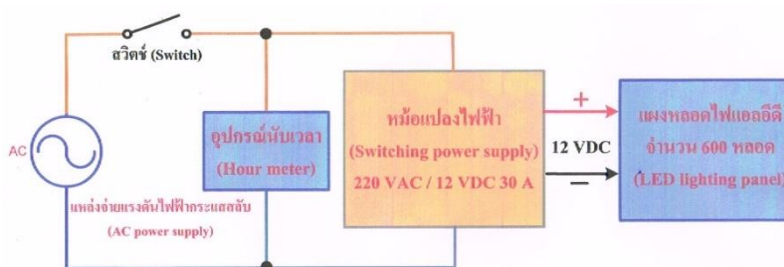
ภาพที่ 3 วงจรไฟฟ้าเครื่องส่องไฟรักษาทารกแรกเกิดภาวะตัวเหลืองแบบประหยัด
